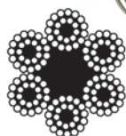
構成6×24 24本線6より中心および 各ストランド中心繊維
