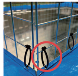
③ ナイロンバンドで底板と本体を固定する 取付後、余った部分をカットする
